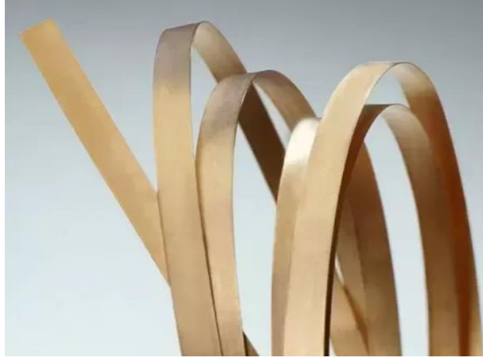
Fig 5.8: BSCCO 2223 HTS cable [J yang et.al]
