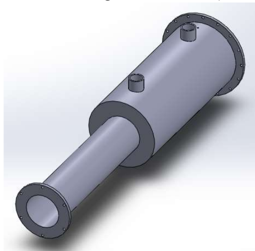
Fig: 4.2. Inlet section CAD assembly
